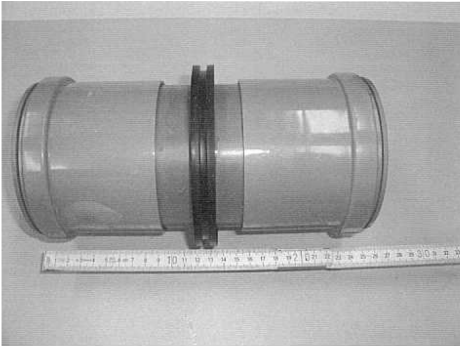
Bild 3: Für die Prüfung verwendetes DOC-System d_n 100
